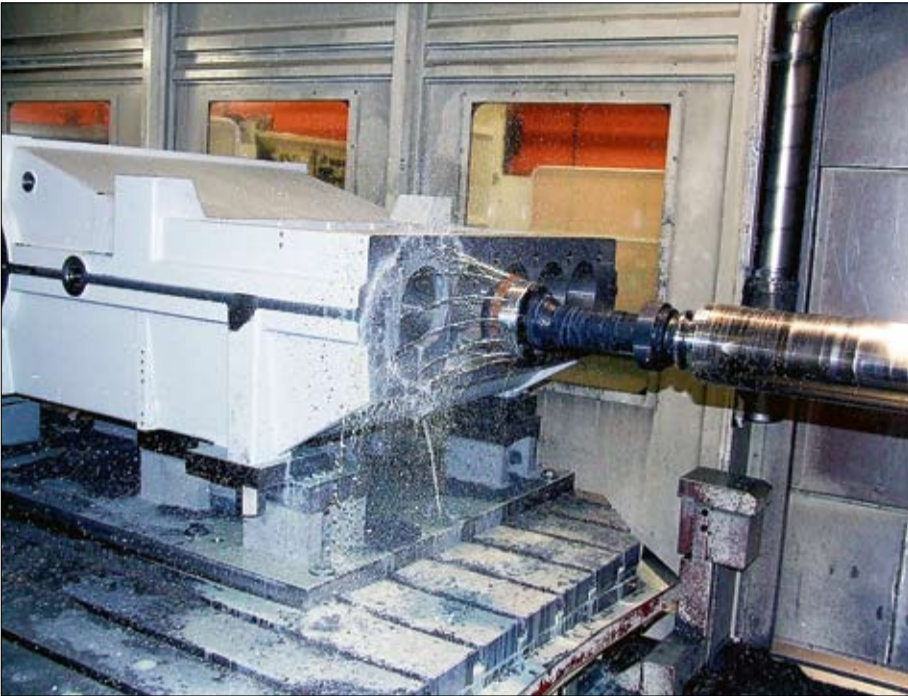
Total längden med W-axel är 900 mm vilket ger ett långt uthäng som är vibrationsbenäget.
