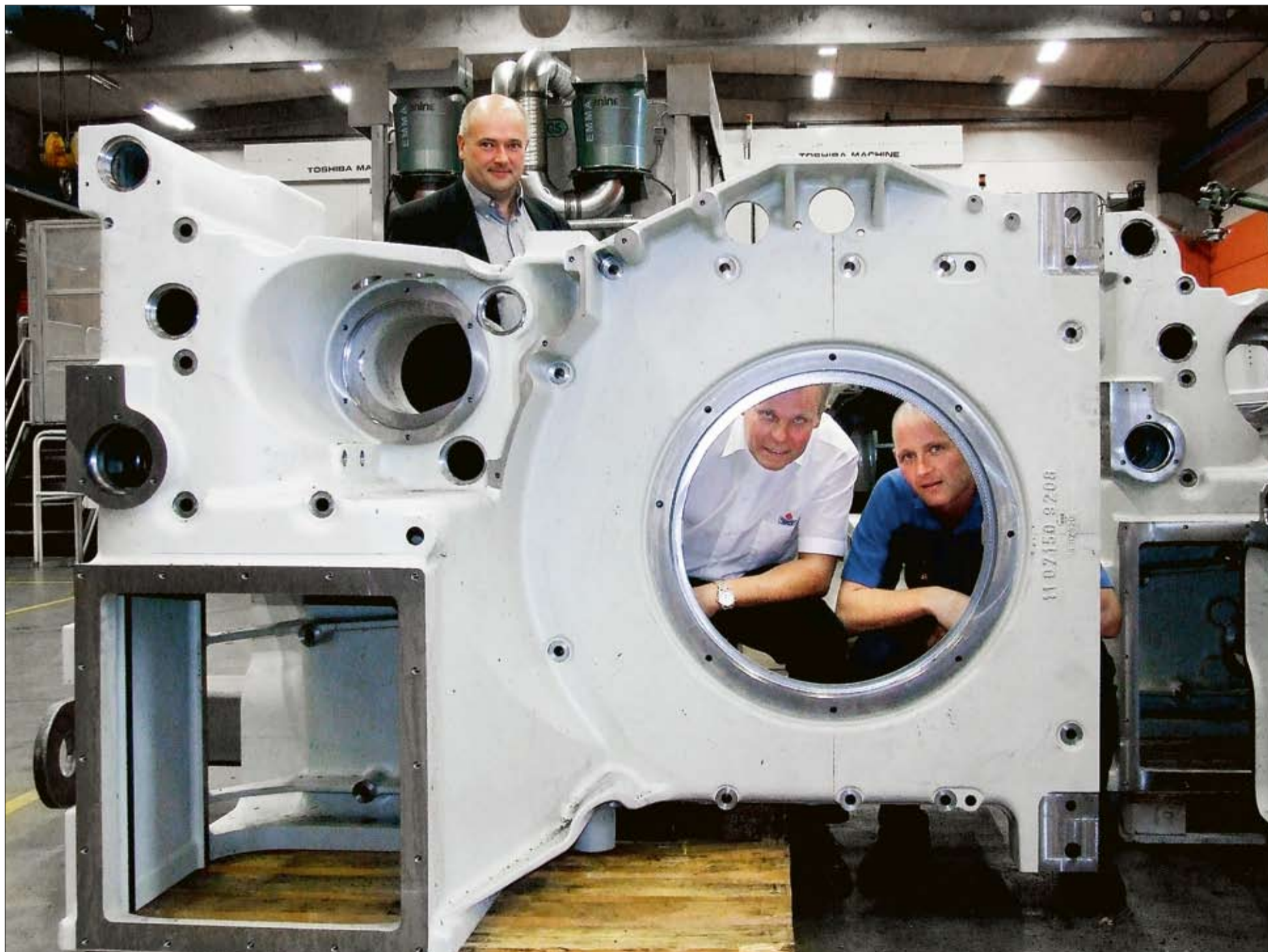
På bilden ser vi ett vevhus på 1 500 kg till en förpackningsmaskin tillverkad för Tetra Pak. Stora genomgående hål – de längsta 900 mm och med en diameter på 155 mm, skall här bearbetas och det sker efter lyckade tester, nu med brotschning istället för arborming. Glada för de lyckade resultaten är Anders Wahlqvist, Johan Norrena och Johnny Hjeltn.
